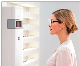
Das „**i.Terminal 2**“ erfasst **ALLE** für die Anpassung von modernen Brillengläsern notwendigen Parameter wie monokulare Zentrierpunktabstände, Fassungsvoorneigung, Hornhautscheitelabstand (HSA) und Fassungsseibenwinkel.
